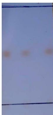
Figura 3: CCD do lapachol em sistema eluente de acetato de etila/n-hexano (3:7)
