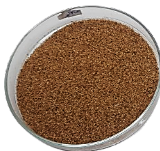
Figura 1. Aspecto da amostra de CP após lavagem, secagem, trituração e peneiramento.
