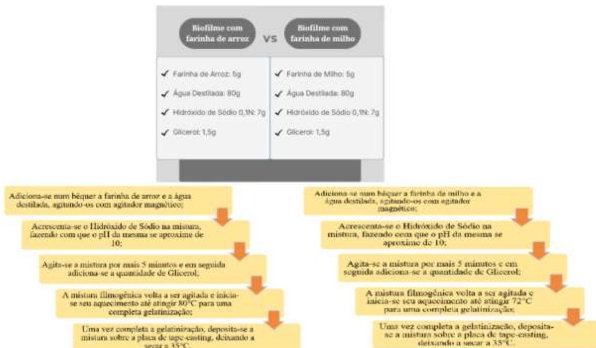
Figura 1 – relação de materiais e fluxograma de Produção em bancada
