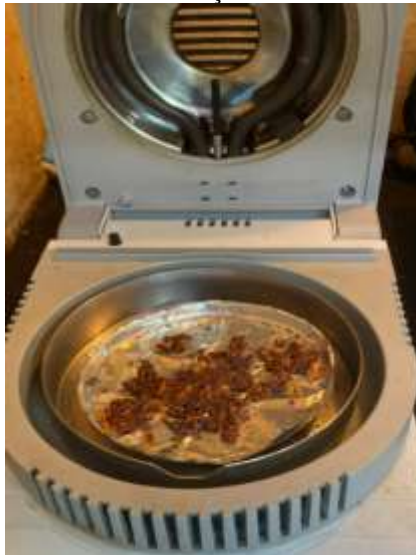
Figura 3 – Resíduo na balança determinadora de umidade
