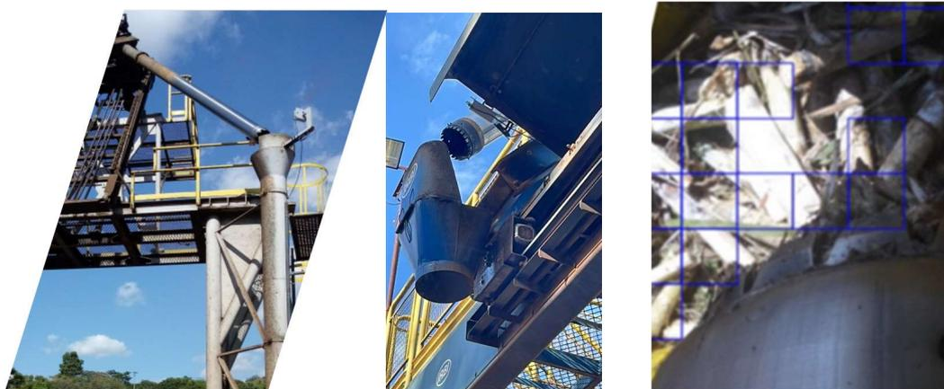
FIGURA 01 – Sistema de captura das imagens sequenciais na sonda amostradora de cana
