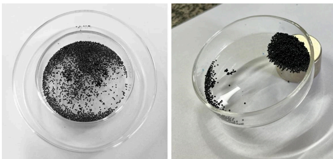
Figura 1. Esferas magnéticas revestidas com quitosana obtidas por método de Co-precipitação de \text{Fe}^{2+} e \text{Fe}^{3+}
