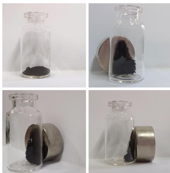
Figura 2. Nanopartículas magnéticas ( \text{Fe}_3\text{O}_4 ) obtidas por método de Co-precipitação de \text{Fe}^{2+} e \text{Fe}^{3+}
