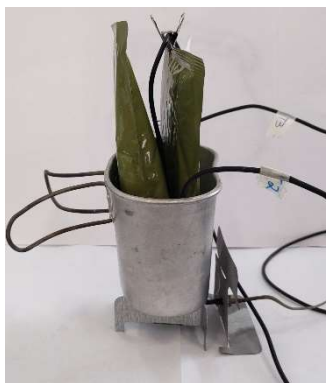
Figura 3: Sistema de monitoramento da temperatura de aquecimento da água em um banho-Maria dentro de um caneco de alumínio.
