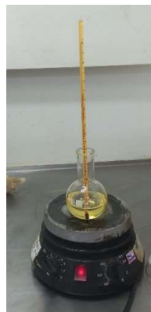
Figura 3: sistema de aquecimento do óleo.
