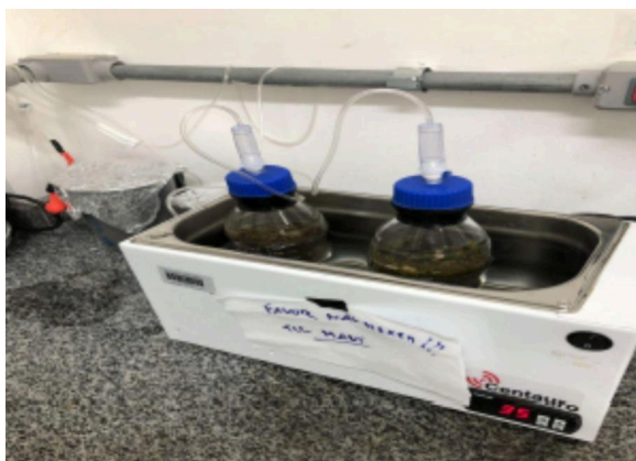
Figura 1 – Processo de biodigestão anaeróbia com controle de temperatura.
