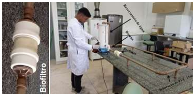
Figura 2 – Dispositivo construído para tratamento de água destinada para o consumo humano
