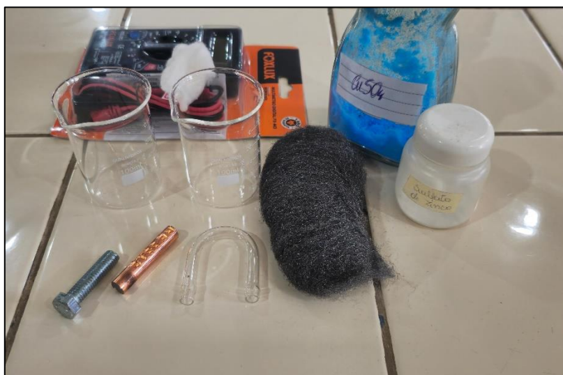
Figura 1. Material básico distribuído aos grupos para a montagem da pilha de Daniell.
