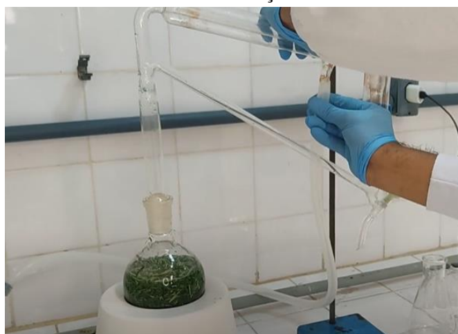
Figura 1 – Sistema de hidrodestilação e óleo essencial obtido.
