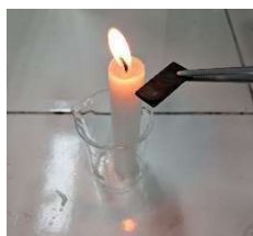
Figura 5. Deposição da camada de carbono no eletródo de FTO.
