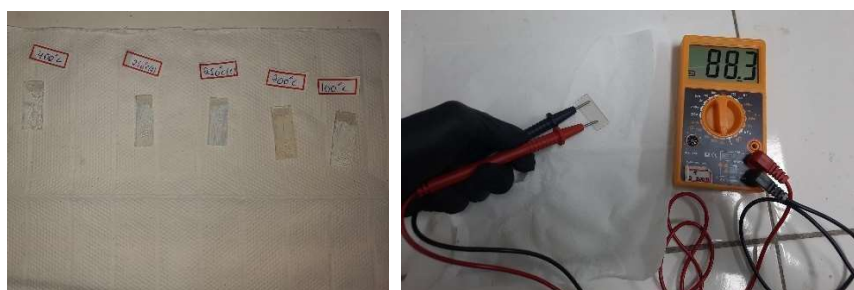
Figura 3. a) Eletrodos de FTO com camada de \text{TiO}_2 , aquecidos em diferentes fontes para formação do grão de contorno. b) teste de condutividade do eletrodo de FTO.
