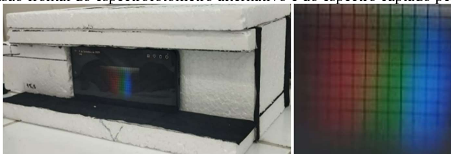
Figura 4. Visão frontal do espectrofotômetro alternativo e do espectro captado pelo celular.
