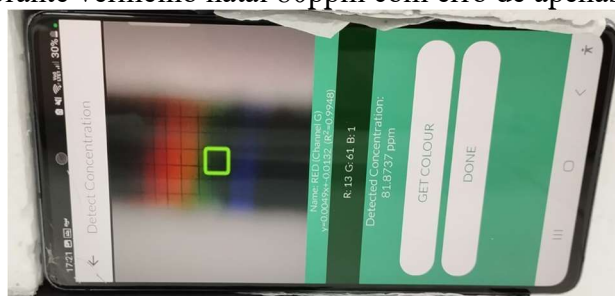
Figura 11. Resultado apresentado pelo espectrofotômetro alternativo para a análise de uma amostra sintética do corante vermelho natal 80ppm com erro de apenas 2,1%.
