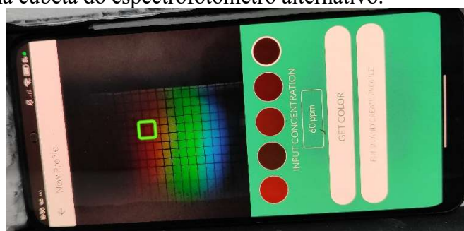
Figura 12. Registros de imagens da região espectral vermelha quando se introduz soluções do corante verde folha na cubeta do espectrofotômetro alternativo.
