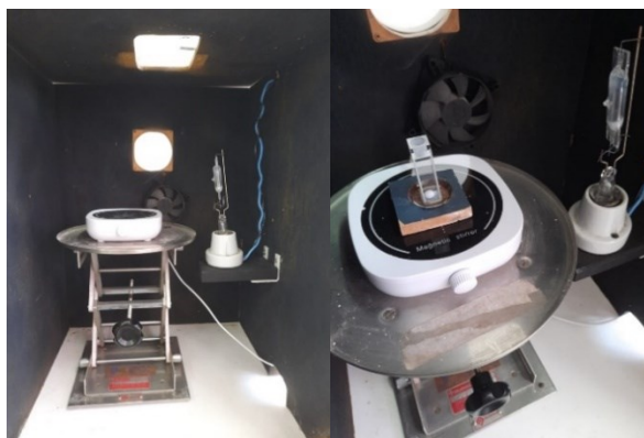
Figura 2 – Fotos do fotoreator empregado nos experimentos de degradação fotocatalítica. Fonte: AUTOR, 2024.
